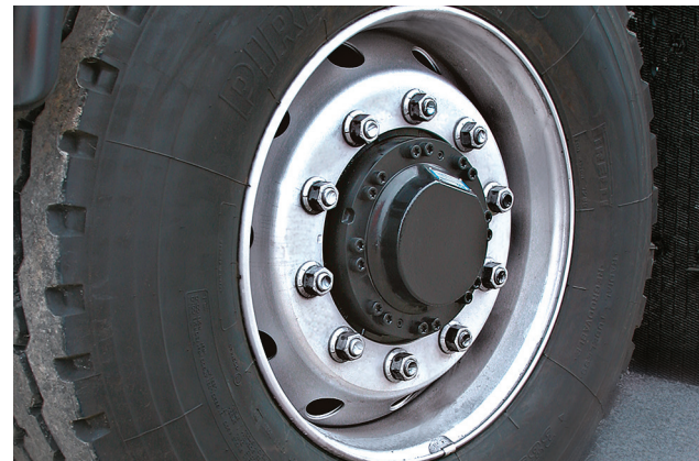
Essieu avant avec moteurs-roues hydrostatiques.
