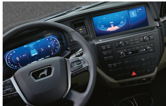
Système d'infodivertissement avec écran 12 pouces et champ de commande sous l'écran secondaire.
