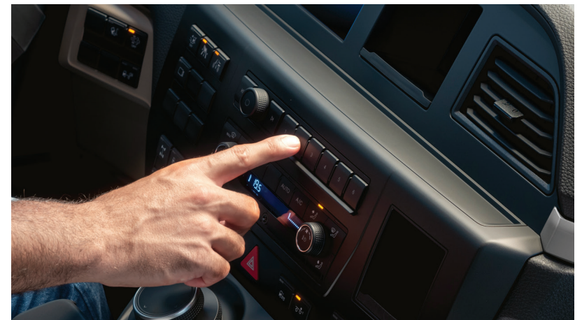
Touches d'accès direct librement configurables avec capteur tactile.
