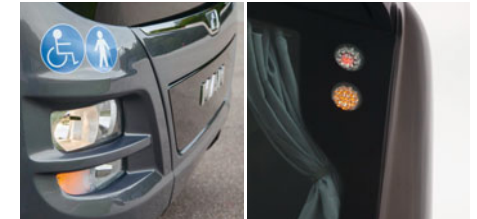
Activation automatique des feux de détresse.
