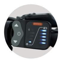
Sélectionnez le niveau d'assistance électrique souhaité indiqué sur la partie gauche du display (du plus faible au plus élevé).
