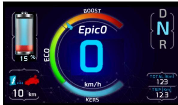
L'état de charge de la batterie de traction est indiqué graphiquement par le symbole de la batterie divisé en cinq segments. La consommation d'énergie est indiquée par l'extinction progressive des segments d'énergie consommée et par un changement de couleur lorsque la batterie s'approche de la réserve et de l'absence de charge.
