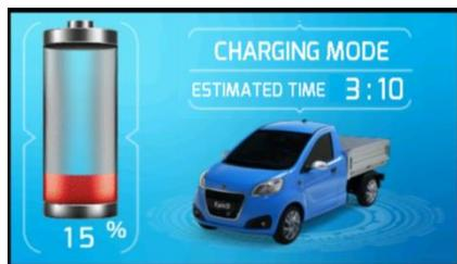
Lorsque vous chargez le véhicule, un écran "CHARGING MODE" apparaît sur le tableau de bord, indiquant le pourcentage de charge et le temps restant estimé en heures et minutes pour une charge complète.
