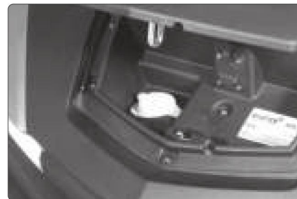
Fig. 25 - Bouchon du réservoir.
