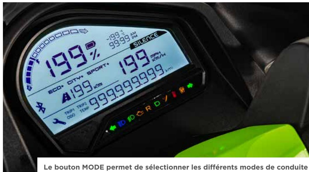
Le bouton MODE permet de sélectionner les différents modes de conduite
