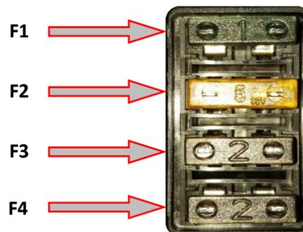
Le scooter dispose de **4 fusibles**, figurant de haut en bas sur l'image (ou de gauche à droite sur le scooter) :
