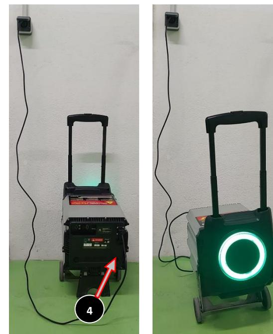
**Avant d'introduire ou de retirer le bloc-batterie, s'assurer que le scooter n'est pas en cours de recharge et que le contact n'est pas enclenché.**
