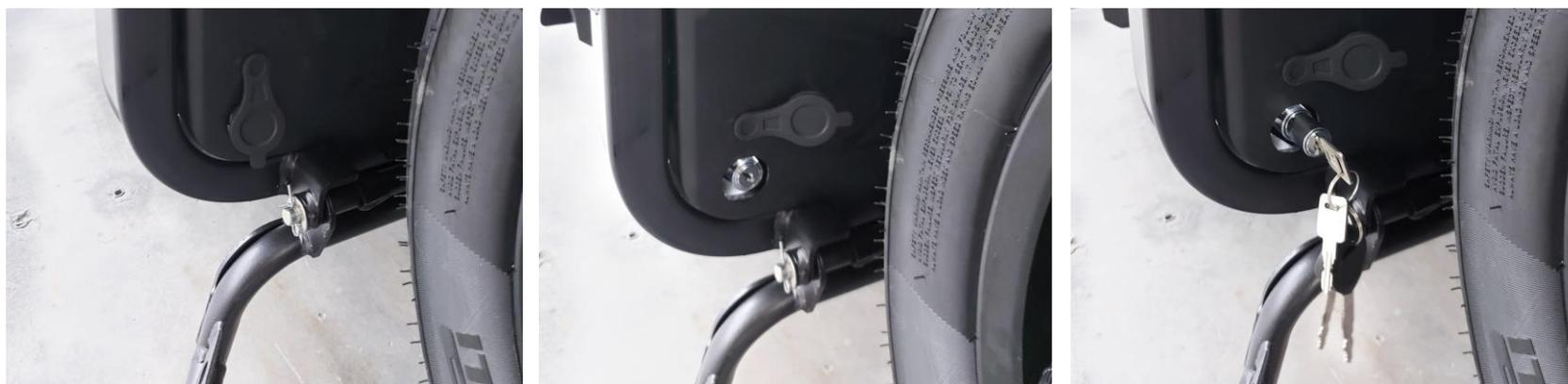
**IMPORTANT** : Veillez à ne pas retirer ni insérer le bloc-batterie lorsque le scooter se recharge ou lorsque le contact est mis. Veillez à **ne pas déployer la poignée avant de retirer le bloc** (ne la déployer qu'une fois la batterie hors du scooter), **ni à l'insérer avec la poignée déployée** (la plier avant de l'insérer).
