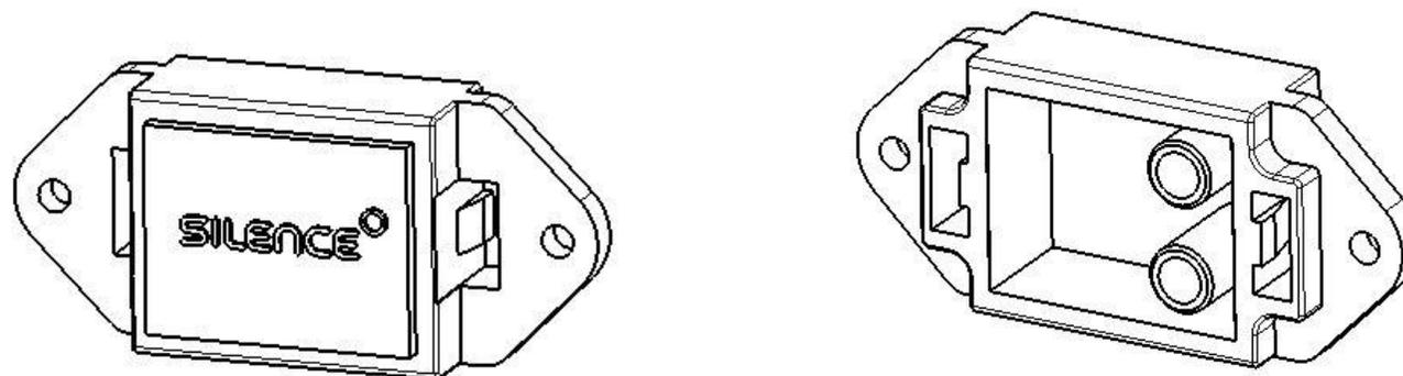
**ATTENTION : Ne pas mettre le cache de protection lorsque le scooter est branché sur le courant, et ne mouiller en aucun cas le connecteur (même si son cache est en place).**
